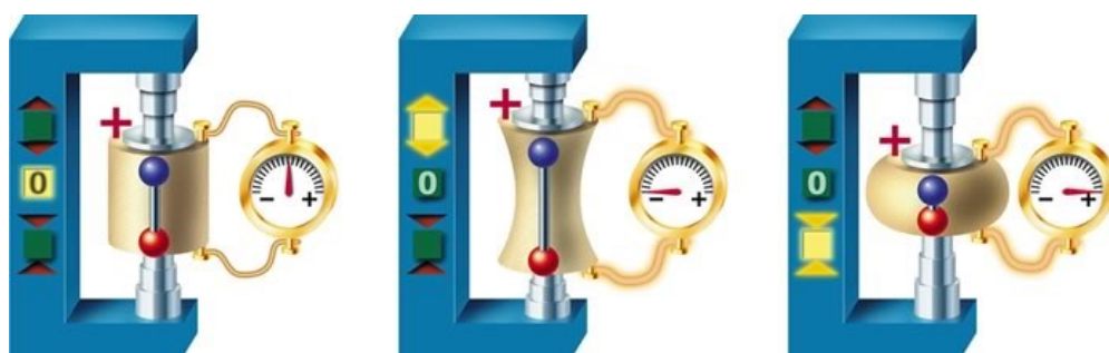
Obr. 6: Přímý piezoelektrický jev [22]
