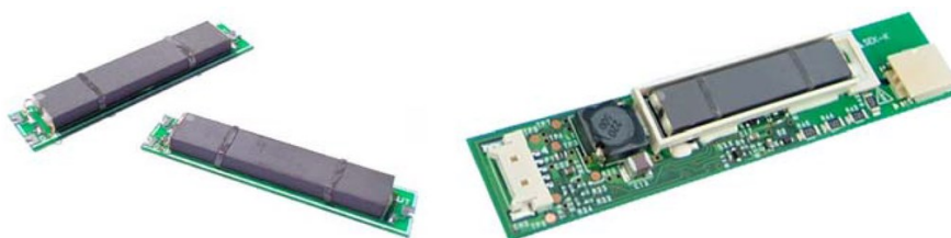
Obr. 10: Aplikace PT na ovládací jednotce LCD displeje Apple PowerBook [40]
