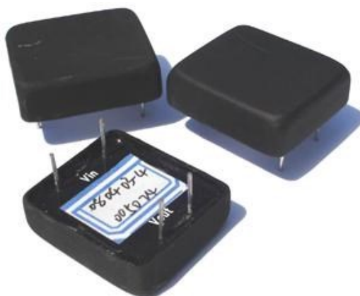
Obr. 40: Vzhled obdélníkového pouzdra step-down PT [34]
