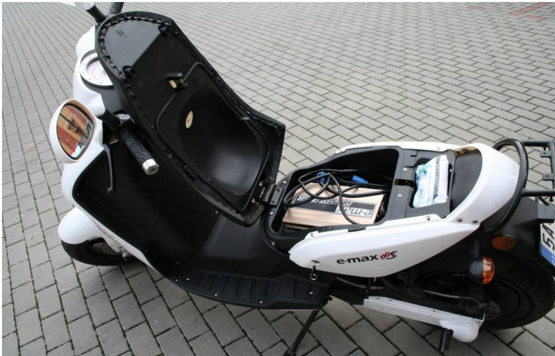
Obr. 6.2 umístění baterií ve skútru E-max 110S ( www.hybrid.cz )
