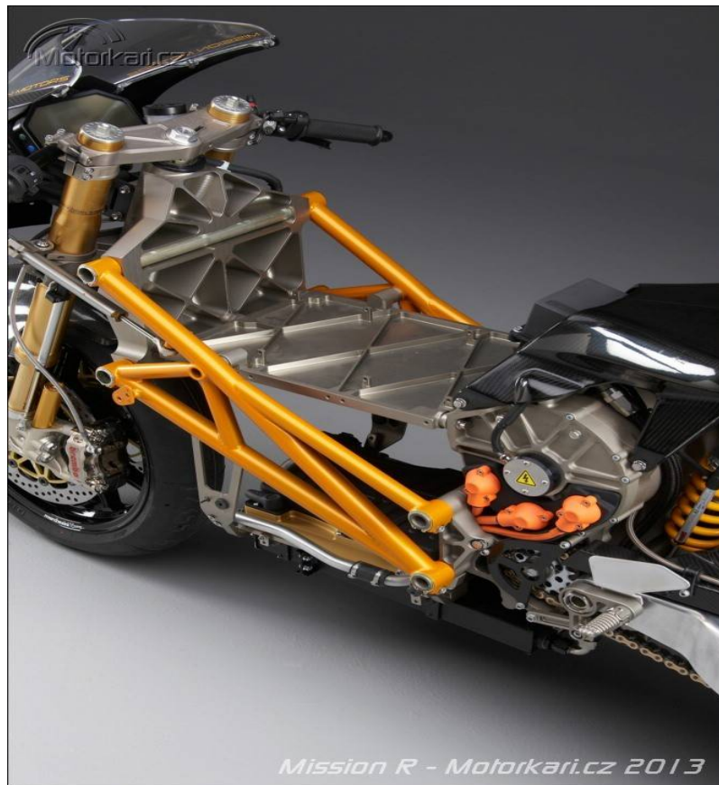
Obr. 6.1 umístění elektromotoru a držák baterií na motocyklu Mission R ( www.motorkari.cz )
