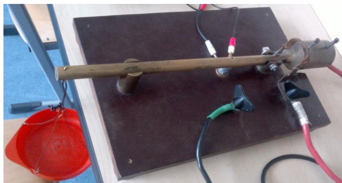
Obr. 3.5.2 Přípravek pro vkládání vzorků kontaktů
