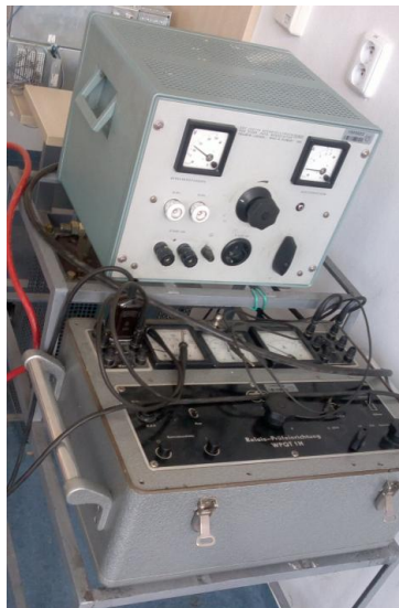
Obr. 3.5.1 Původní zdroj proudu pro měření kontaktů
