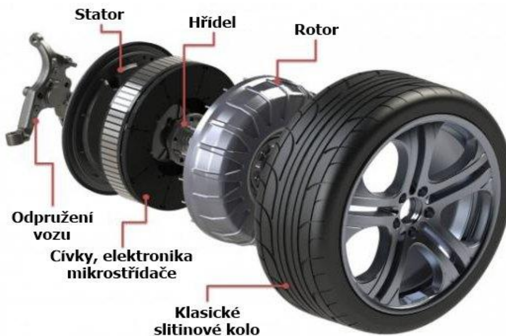
Obr. 2.1 Schéma motoru v kole [5]
