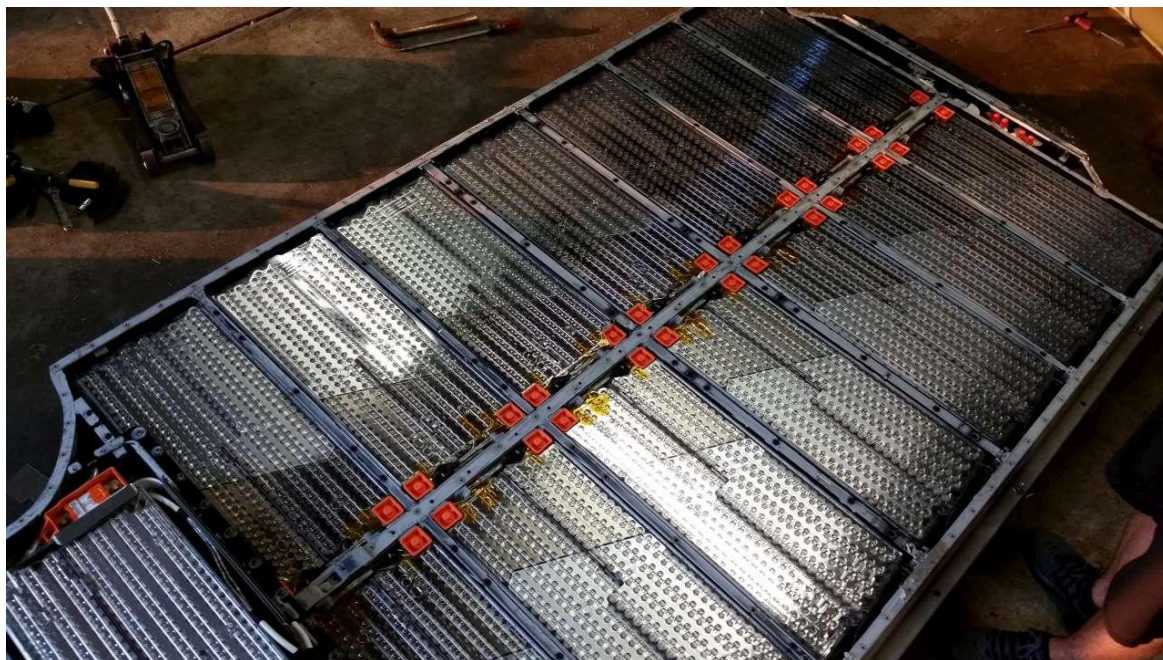
Obr. 2.3 Baterie složená z 7104 ks Li-Ion článků [7]
