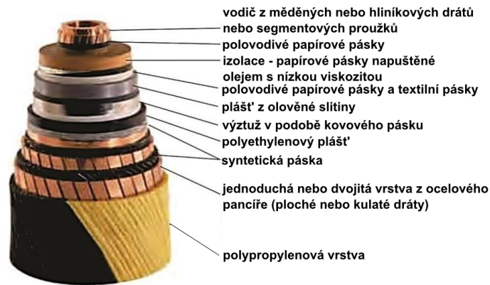
Obrázek 2.1: Struktura kabelu SCFF [12]
