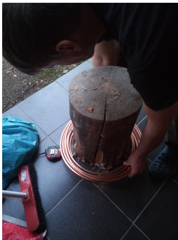
Příloha č. 2: Ohýbání primární cívky přes špalek stromu
