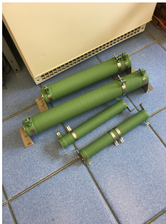
Obr. 5.5: Reálný pohled na použité rezistory.
