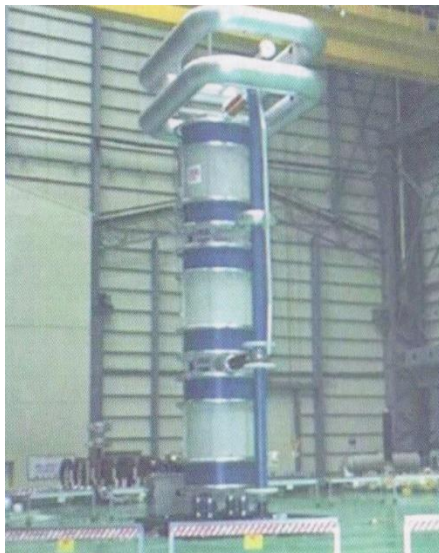
Obr. 10 Kaskáda z tří tlumivek o celkovém napětí 1200 kV, každá tlumivka 400 kV [1]
