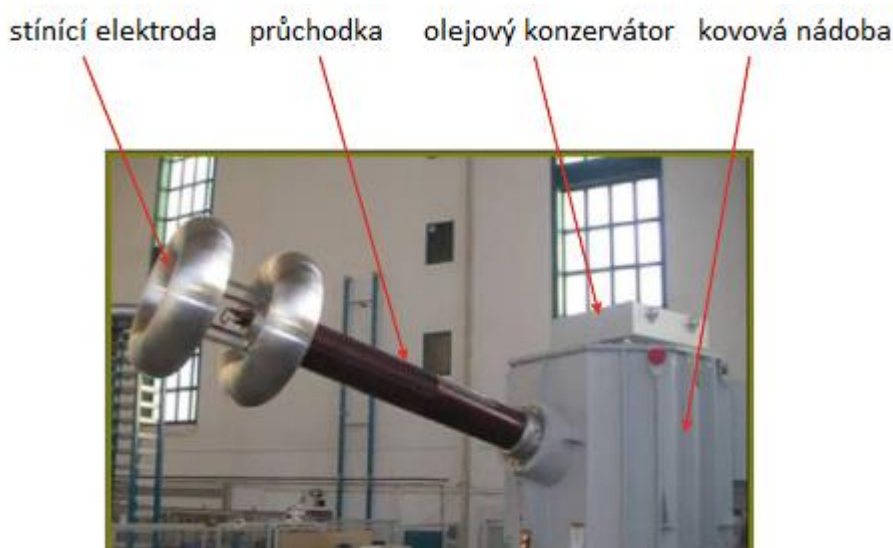
Obr. 5 Zkušební tank-type transformátor (2 MVA) [1]
