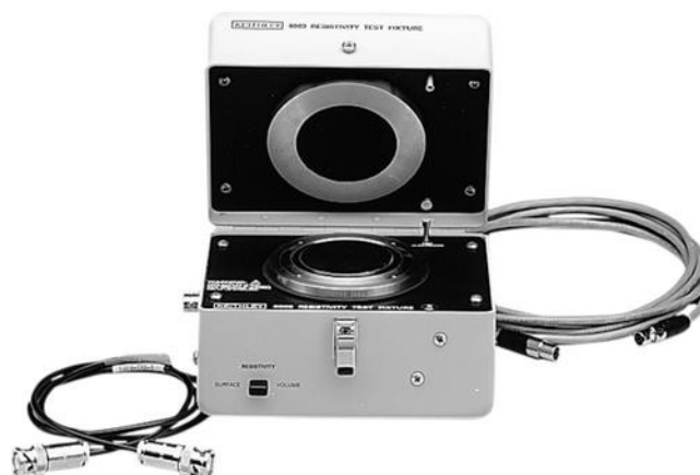
Obr. 21 Testovací komora Keithley 8009 [34]
