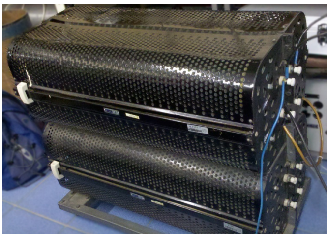
obr. 5.1.7 – použité odpory 2x 8,4 kΩ
