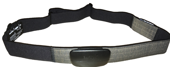
Obrázek 3.2: Hrudní pás Garmin. Uprostřed pásu se nachází výpočetní a vysílací prvek. Na obou stranách od něj se na vnitřní straně nachází elektrody.
