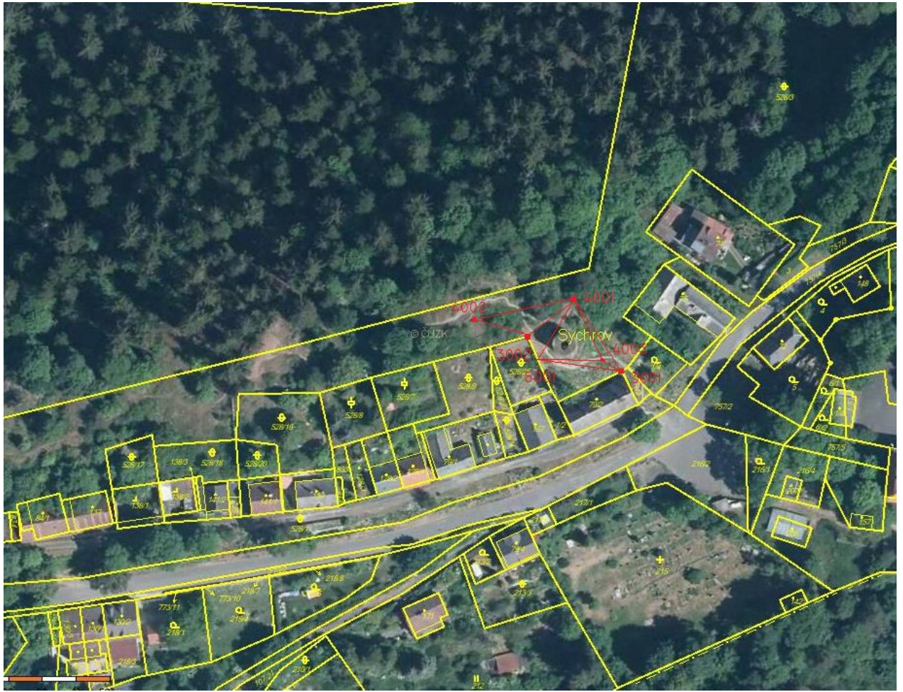
Obr. 18: Model vytyčeného zaměřovacího polygonu na lokalitě.
