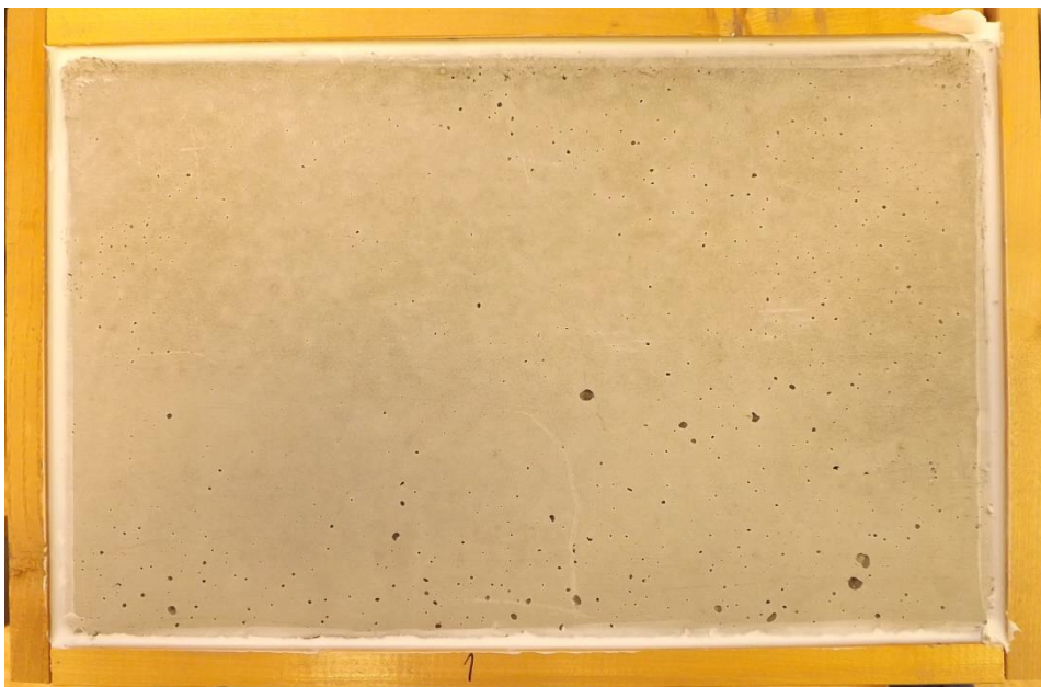
Obr. 6 Betonová deska s hladkým povrchem v dřevěné formě
