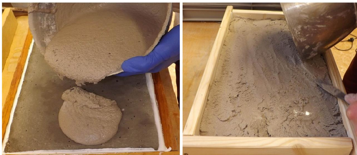
Obr. 7 Nanášení hlinitokřemičité vrstvy
