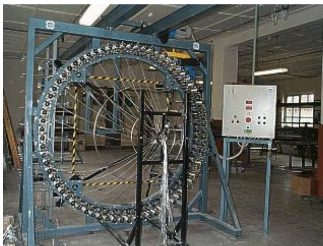
Obr. 13 Výroba kompozitů metodou splétání (převzato z [17])
