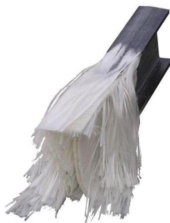
Obr. 1 Vyztužení profilu skleněnými vlákny (převzato z [13])
