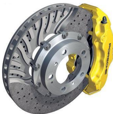
Obr. 5 Brzda vyrobená z kompozitu s keramickou maticí (převzato z [6])
