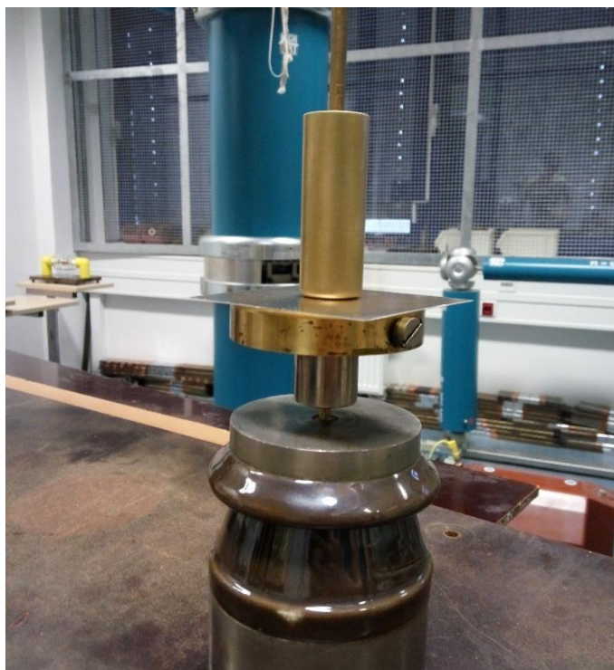
Obr. 29 Měření klouzavých výbojů
