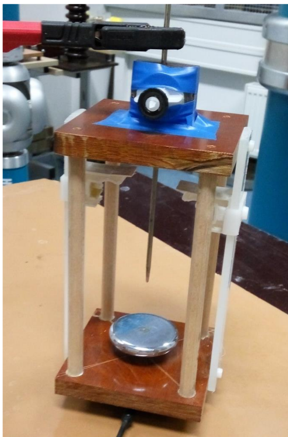
Obr. 23 Model uspořádání hrot-deska
