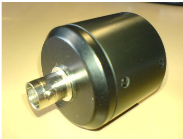
Obr. 9 Kapacitní sonda výrobce Lemke Diagnostic (převzato z [11])
