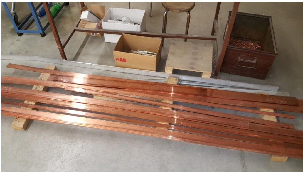
Obrázek 3.8: Různé velikost měděných pásů
