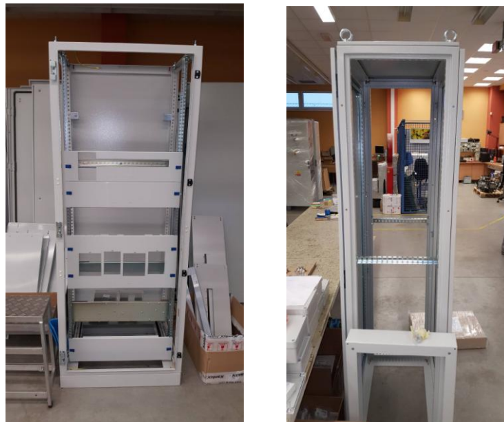
Obrázek 3.4: Prázdná skříň rozvaděče
