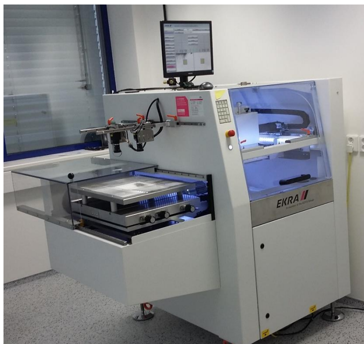
Obr. 3.3 Poloaufomatický sítotiskový stroj Ekra E2 v laboratoři Regionálního Inovačního Centra Elektrotechniky Západočeské univerzity v Plzni
