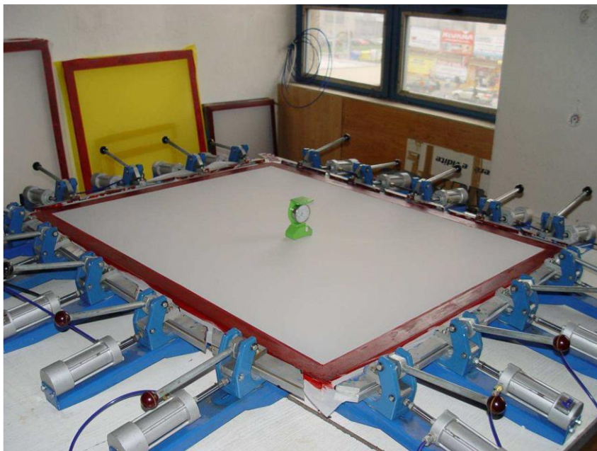
Obr. 1.4 Měření napnutí sítoviny po přilepení k rámu v napínacím zařízení (převzato z [4])
