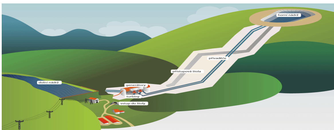
Obr. 19. Schéma přečerpávací elektrárny s přivaděči (převzato [34])
