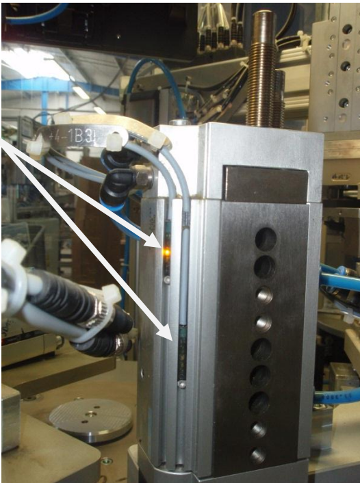
Obr. 3.2 Detailní pohled na umístění senzoru firmy Festo SMT-10F-PS-24V-K0,3L-M8D
