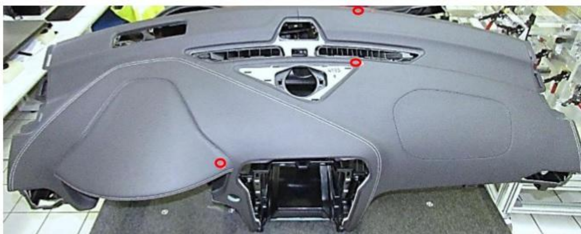
Obr. 22: Zkoušená přístrojová deska a znázornění oblastí, které byly zdeformovány testem
