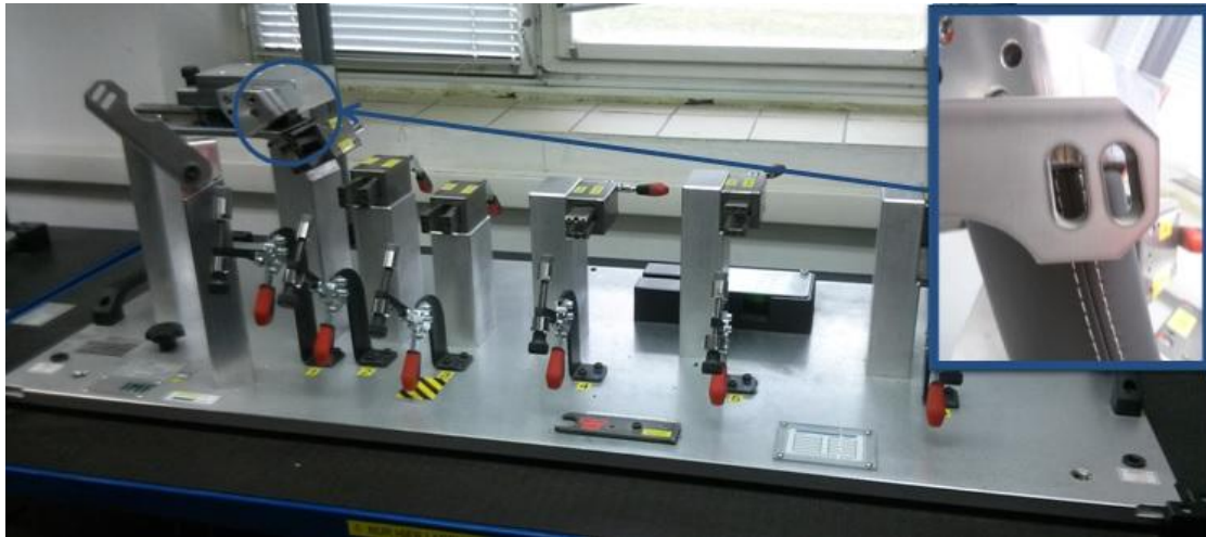
Obr. 29: Kontrola polohy provedení švů u Side railů
