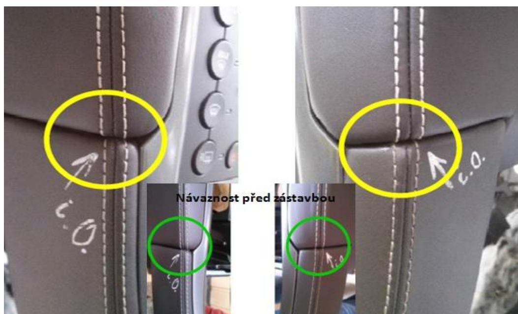
Obr. 33: Návaznost švů součástí po zástavbě do nominálního modelu automobilu
