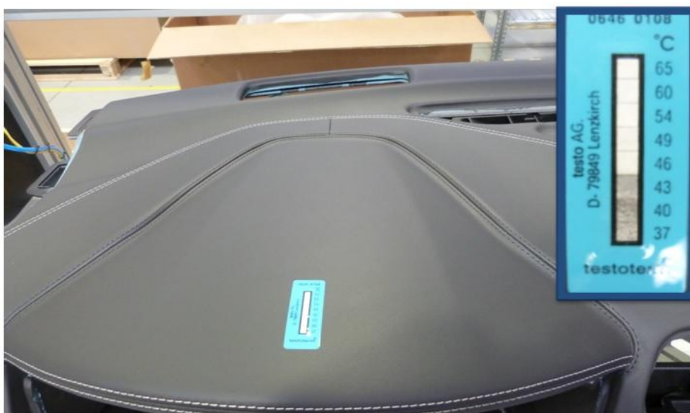
Obr. 23: Samolepící teplotní indikátor na přístrojové desce a detail indikátoru znázorňující teplotu
