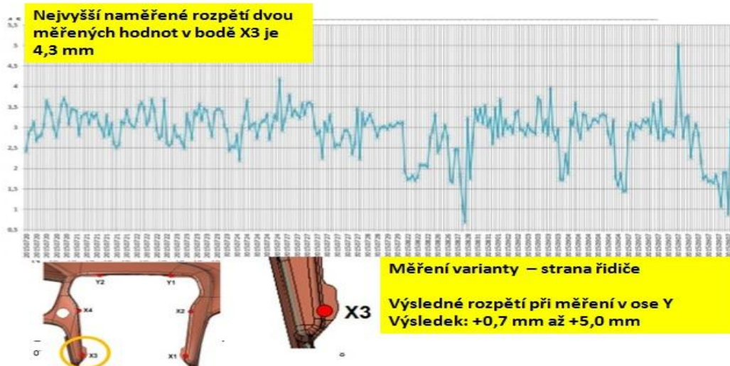
Obr. 31: Výsledky měření 283 kusů a výsledná variabilita v bodě X3
