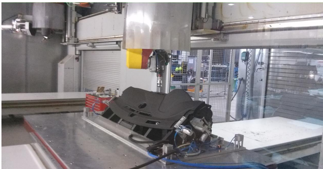
Obr. 24: Proces měření přístrojové desky pomocí sondy ve frézovacím centru
