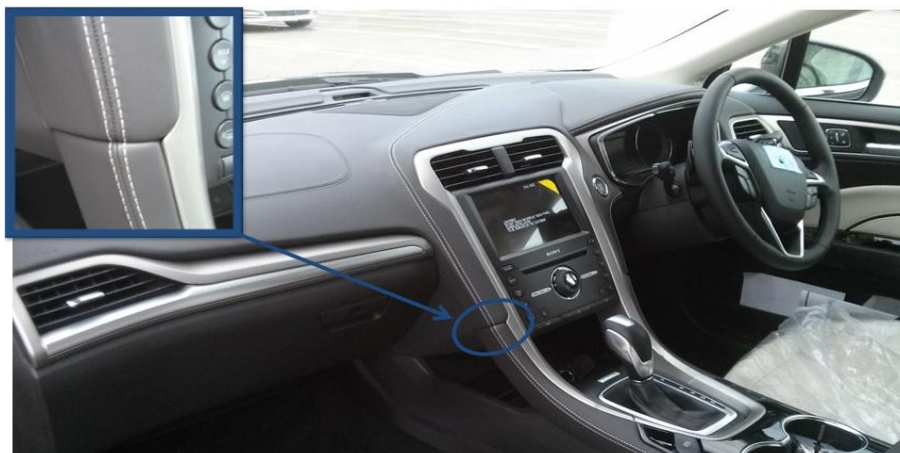
Obr. 20: přístrojová deska se zabudovanými bočními lištami, detail návaznosti švů u dílů
