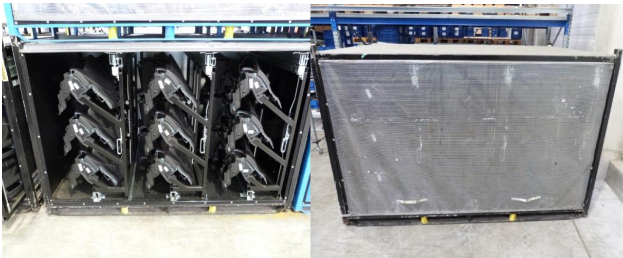
Obr. 37: Vzhled nových obalů, používaných k přepravě přístrojových desek.
