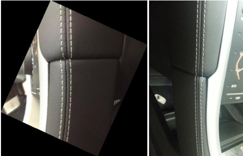
Obr. 15: Návaznost švů přístrojové desky a Side Railu v praxi – již zastaveno v automobilu. Vlevo NOK stav, vpravo OK stav
