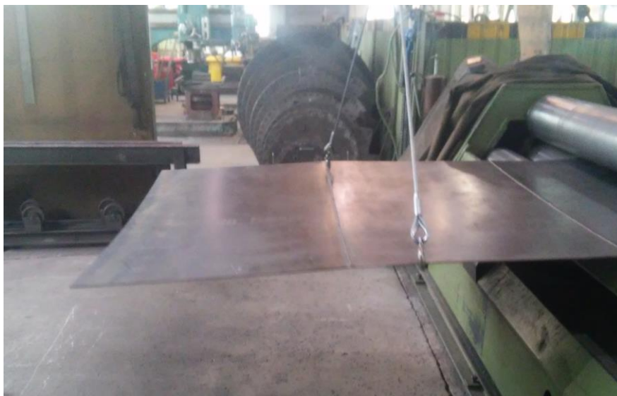
Obr. 4.1 Zablokování pracoviště a uličky při zakružování
