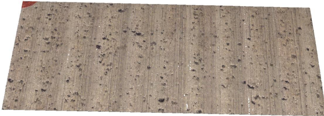
Obrázek 48: Scan obrobeného povrchu s nejlepším parametrem profilové drsnosti [30]
