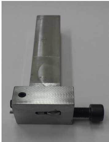
Obrázek 21: Držák soustružnického nože označen číslem 1 s VBD [29]
