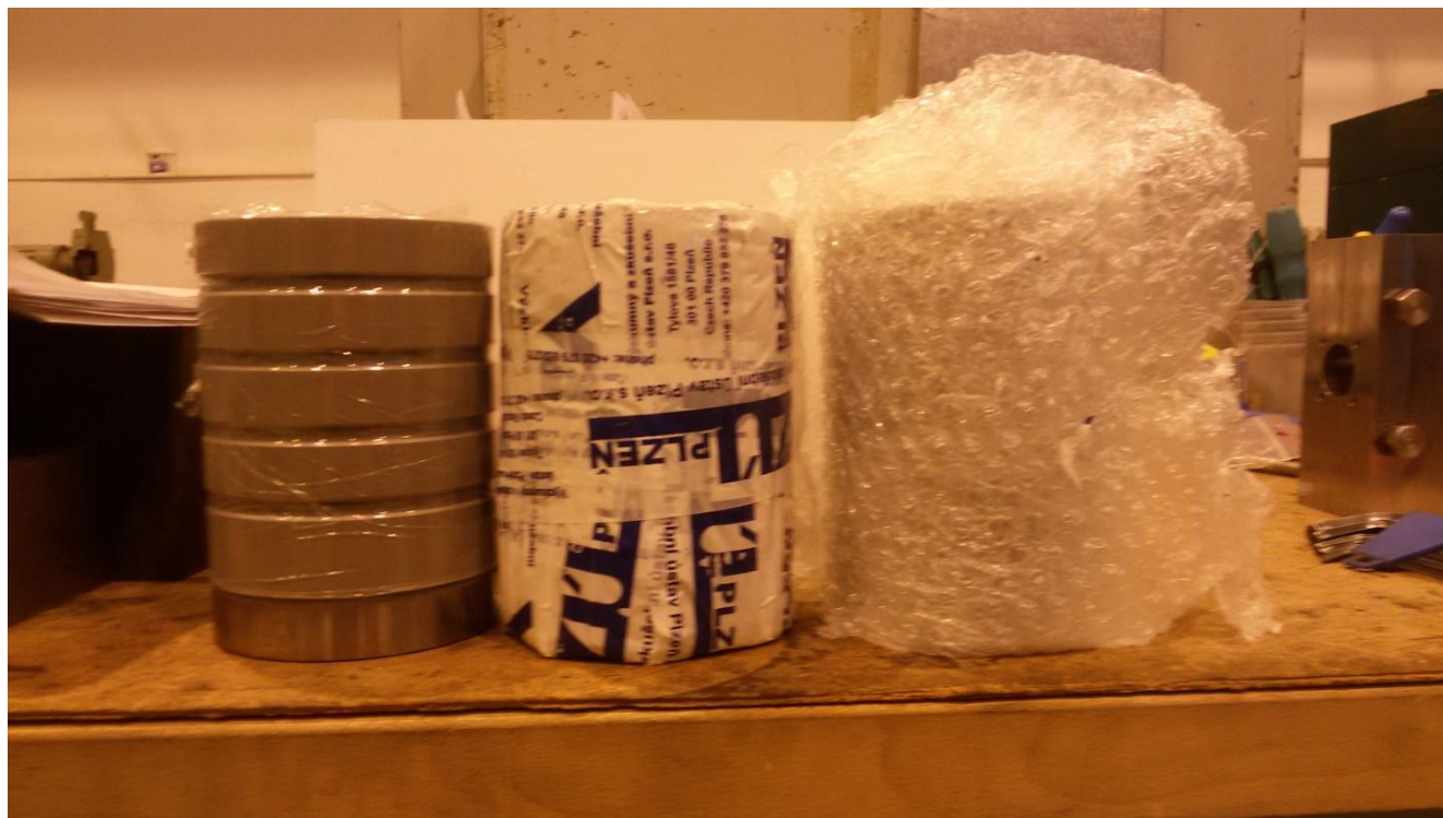
Obrázek 27: Zkušební vzorky s žárovým nástřikem slitiny stelit 6
