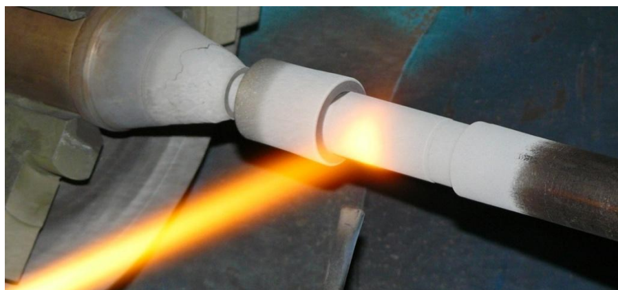
Obrázek 6: Žárový nástřik metodou HVOF [18]
