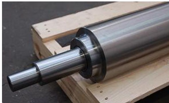
Obrázek 3: Žárový nástřik prořezávacího válce [11]
