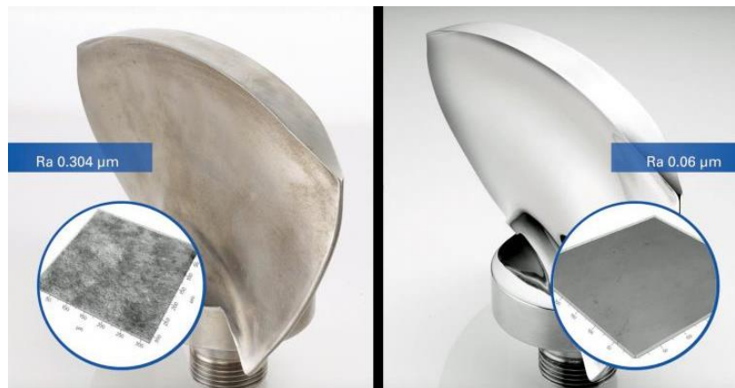
Obr. 2.9 Zvýšená kvalita povrchu součásti po proudovém omílání [8]
