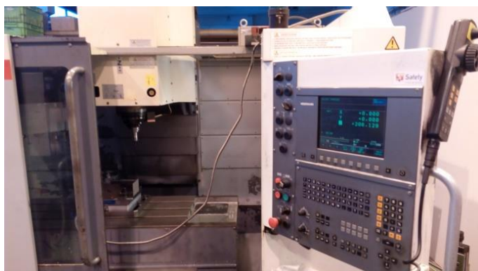
Obr. 3.13 Pracovní prostor a ovládací panel frézovacího centra MCV 70A
