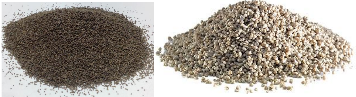
Obr. 2.13 a) Médium H4/400, b) Kukuřičný granulát [10]
