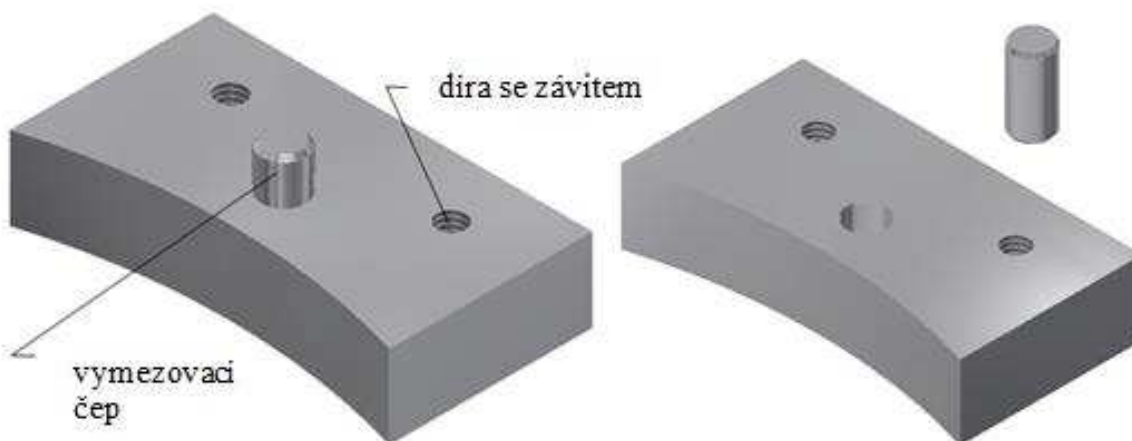
Obr. 16 - Vedlejší jádro (vlevo) a návrh na změnu (vpravo)
