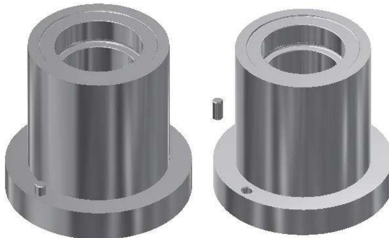
Obr. 15 – Tvárnice 1 (vlevo) a návrh na změnu (vpravo)
