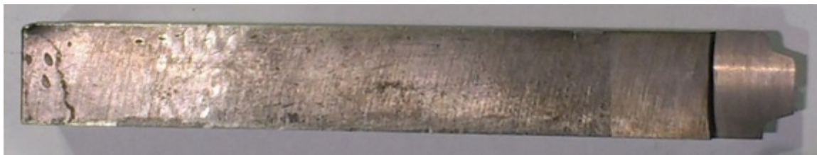
Obr. 11: Tvarový nůž na rádiusy
