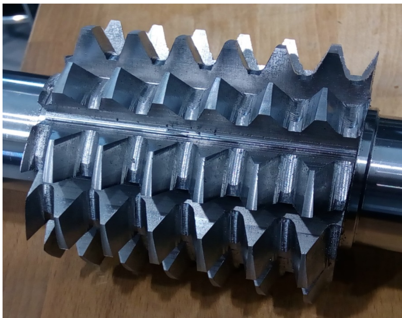
Obr. 42: Odvalovací fréza po obrobení dle druhého způsobu
