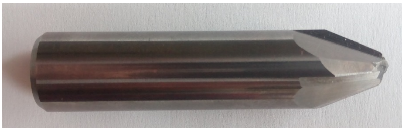
Obr. 41: Čepová fréza s ulomenou špičkou po vyjmutí ze stroje při druhém způsobu
