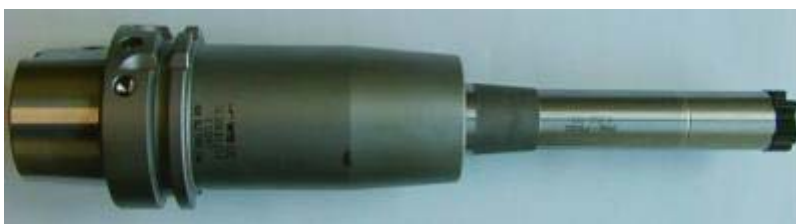
Obrázek 20. Výstružník s tepelně upnutou hlavici MT3 [11]
