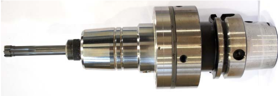
Obrázek 42. VRV výstružník upnutý RC hydroupínači
