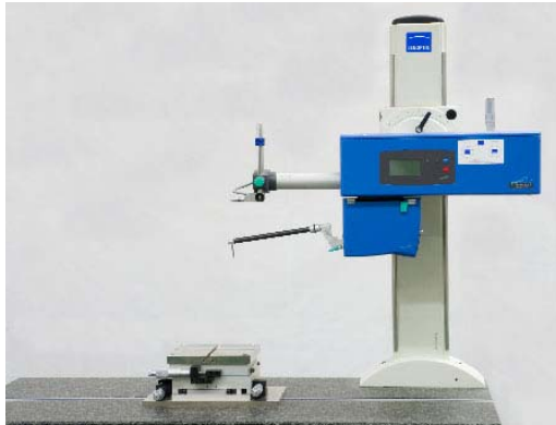
Obrázek 36. Drsnoměr Hommel Etamic T8000 [444]
