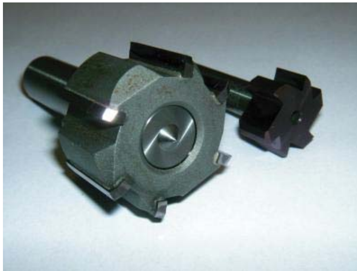
Obrázek 10. Vystružovací hlavice VVH firmy HAM – FINAL [7]
