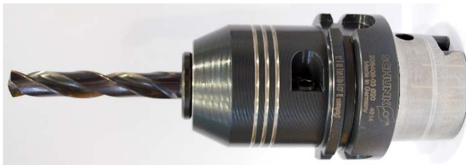
Obrázek 41. Vrták upnutý v hydraulickém upínači
