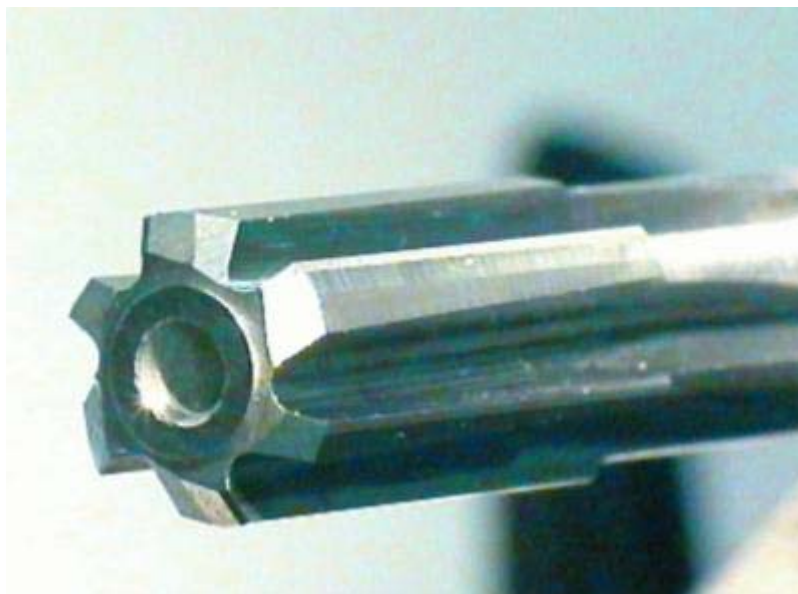
Obrázek 16. Cermetový výstružník s centrálním chladicím kanálem od firmy GÜHRING [10]
