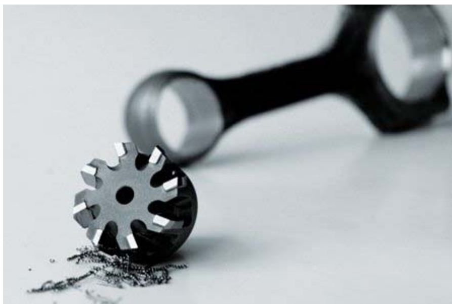
Obrázek 14. Výstružník MAPAL HPR110 s břity z cermetu [9]
