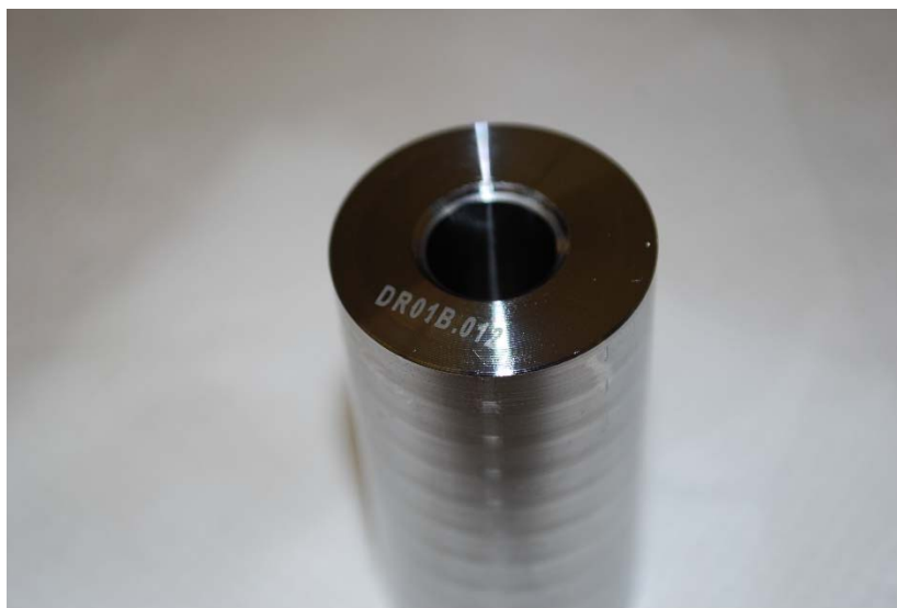
Obrázek 29. Hotový vystružený vzorek popsáný laserem
