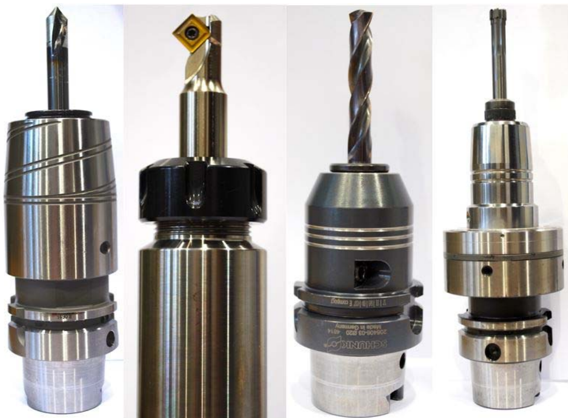
Obrázek 35. Použité nástroje s upínači pro experiment - zleva navrtávák, srážecí hran, vrták a výstružník
