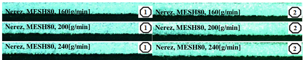
Obrázek 77: nerez - otřepty, zvětšení 20x, MESH80
