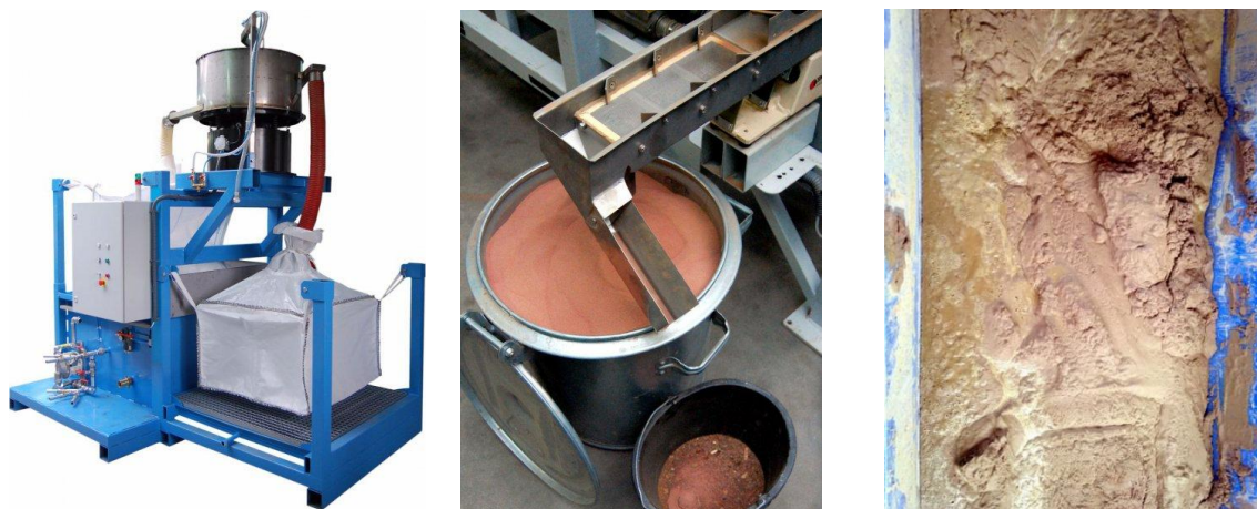
Obrázek 22: zleva: recyklační jednotka RAMS 2, výstup abraziva z recyklační jednotky, abrazivo před recyklací v šnekovém dopravníku[16]
