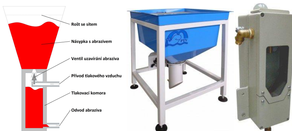
Obrázek 20: a) schéma pulzní dopravy abraziva, b) pulzní dopravník abraziva, c) dávkovač abraziva[16]
