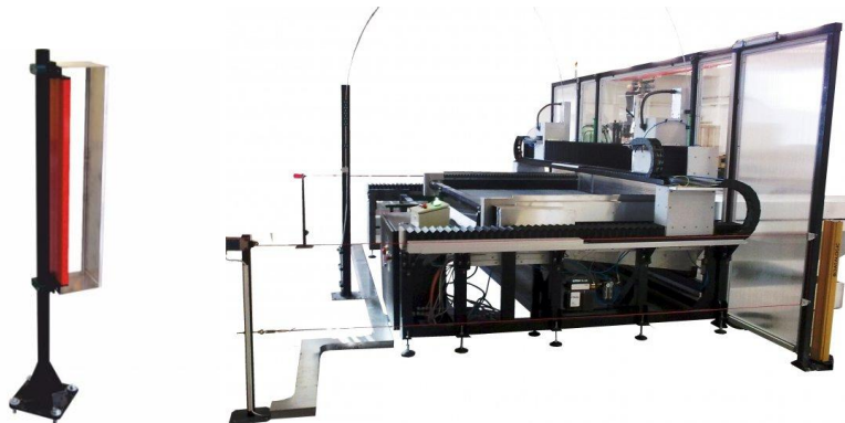
Obrázek 19: Světelná bariéra a lankový systém[16]
