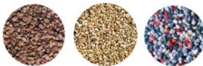
Obrázek 23: Abraziva organická: skořápký ořechů, kukuřičný granulát, plastové abrazivo[17]
