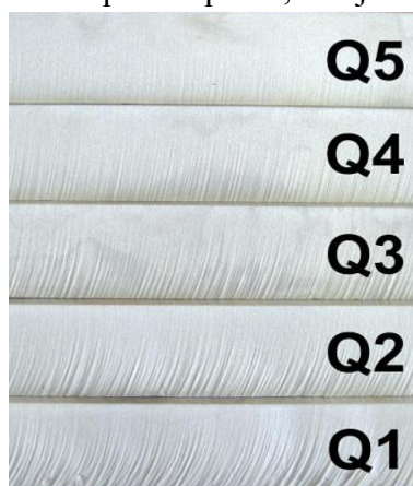
Obrázek 14: Stupně kvality řezu[21]
