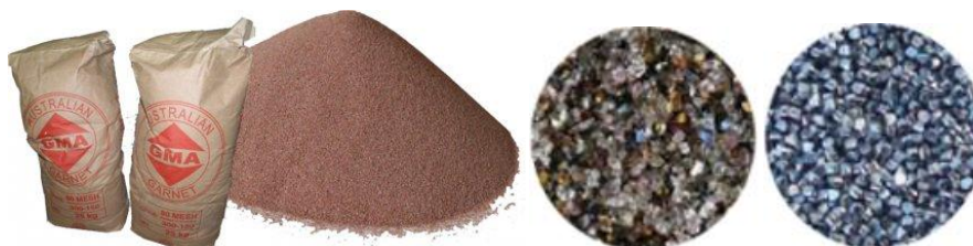
Obrázek 25: Abraziva minerální: granát, korund, karbid[17,19]
