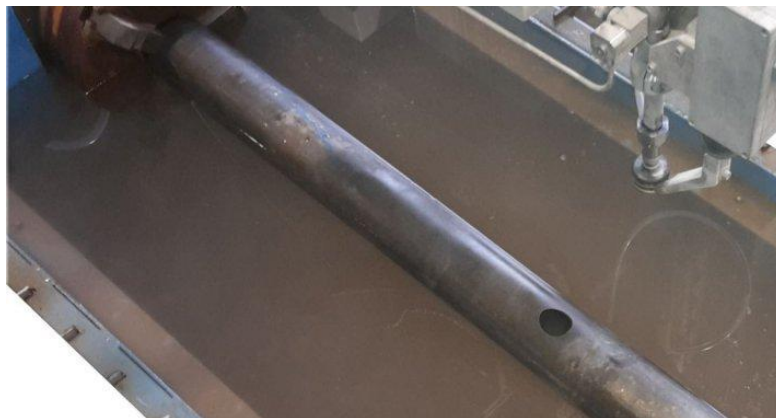
Obrázek 18: Rotační šestá osa[16]
