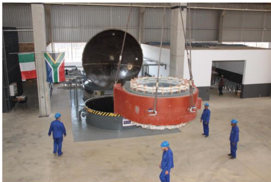
Obr. 1.4: Přeprava statoru do nádoby pro VPI (převzato z [9])
