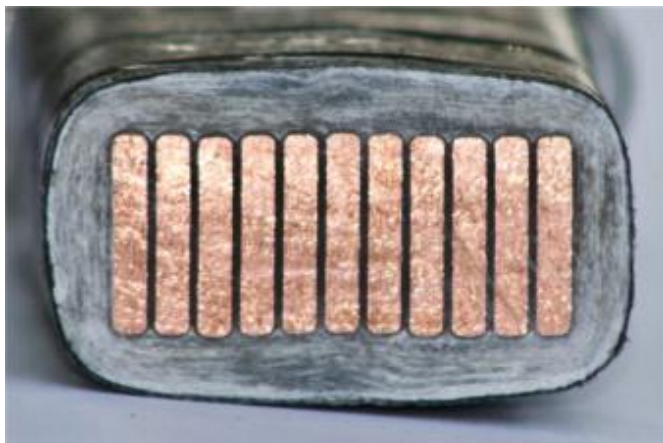
Obr. 1.3: Izolační materiál polyester-imid impregnovaný pomocí VPI (převzato z [10])
