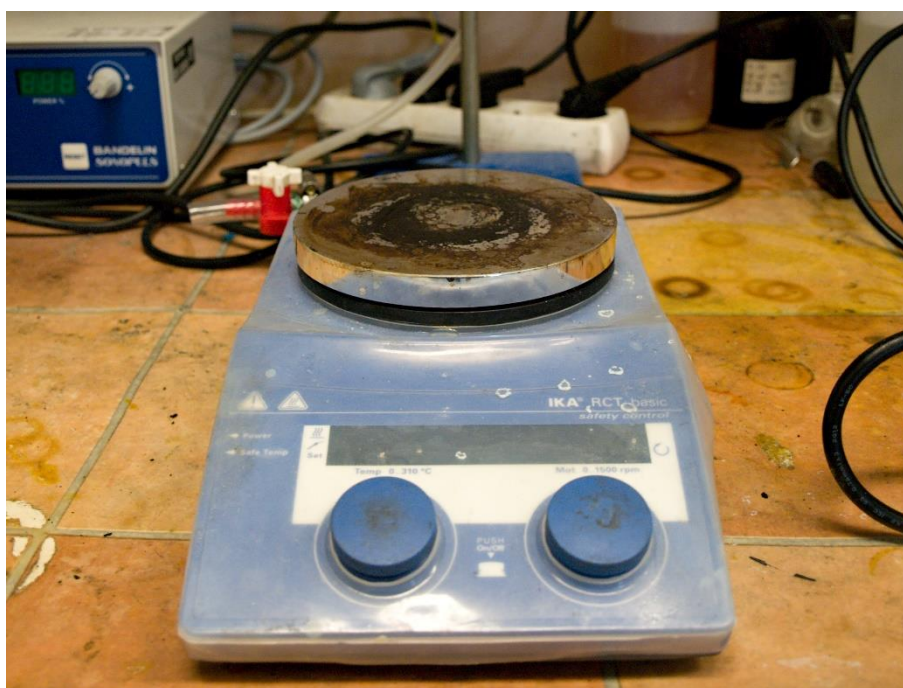
Obr. 2: Elektromagnetická míchačka využitá při procesu míchání a vakuování
