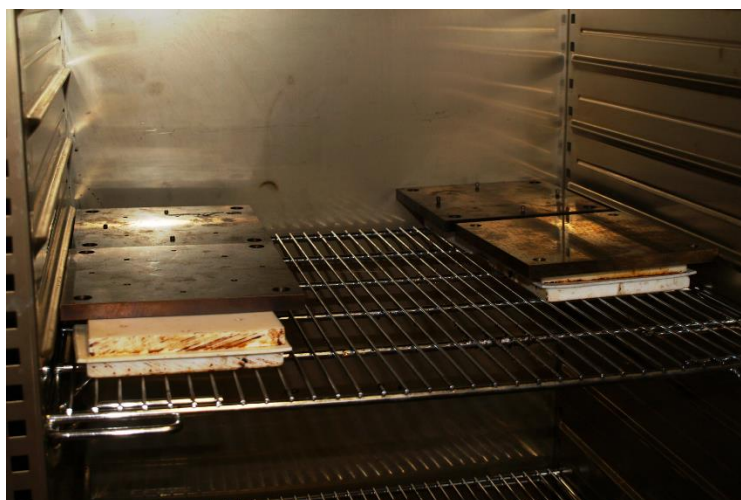
Obr. 4.1: Přikryté vzorky ve fázi gelace připravené pro konečné vytvrzení
