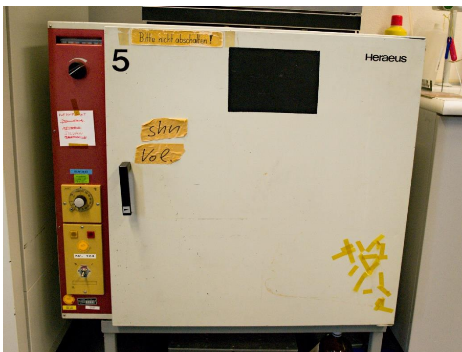
Obr. 6: Sušící pec využita pro stárnutí vzorků
