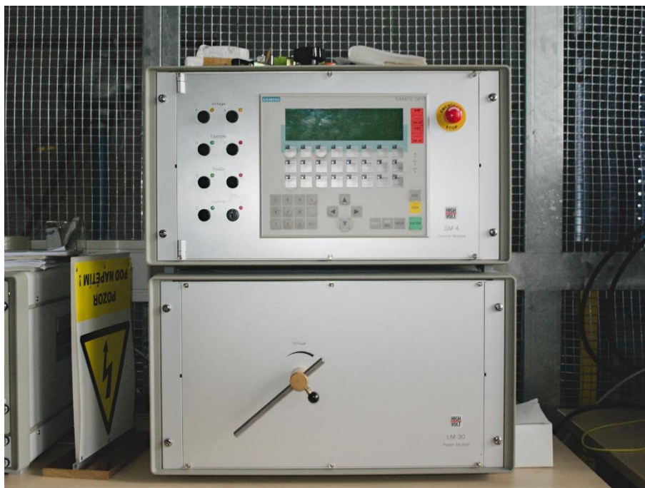
Obr. 5: Automatický měřicí systém LDV pro měření elektrické pevnosti
