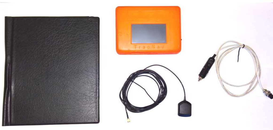
Obr. 6.1: Zařízení TracNav, GPS anténa, napájecí kabel a záznamové desky
