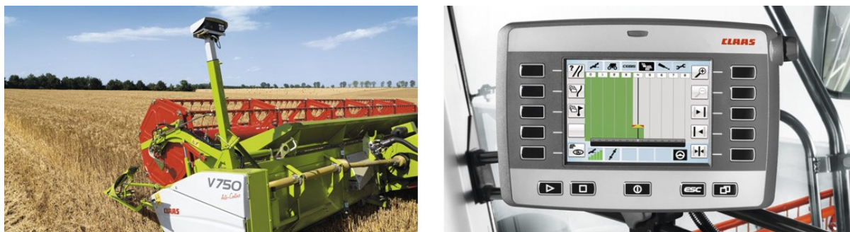
Obr. 2.3: Systémy LASER PILOT a GPS PILOT od firmy CLAAS, převzato z [17]
