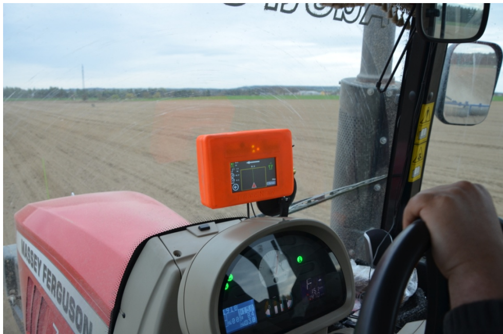
Obr. 4.2: Využívání zařízení TracNav při válení zasetých obilovin
