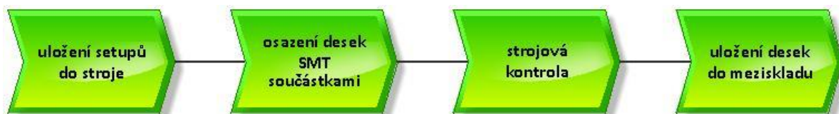
Obr. 5.5 Schéma osazení SMT součástkami (vlastní zpracování – ArisExpress)
