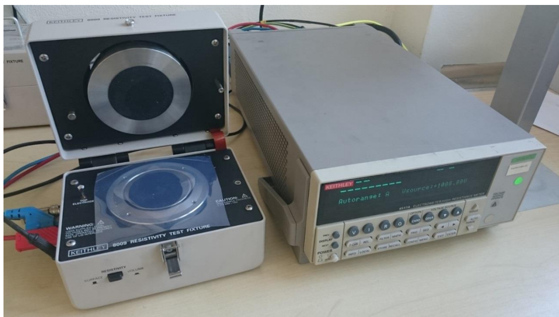
Obr. 8.1. Měřicí systém pro měření prostorového náboje s PEN vzorkem umístěným na elektrodě.
