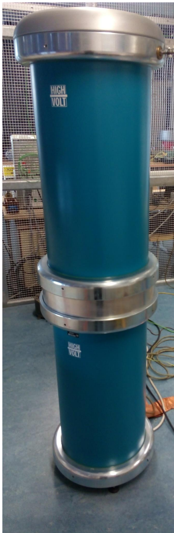
Obr. 4: Zkušební transformátor High Volt PEOI 10/110 10kVA
