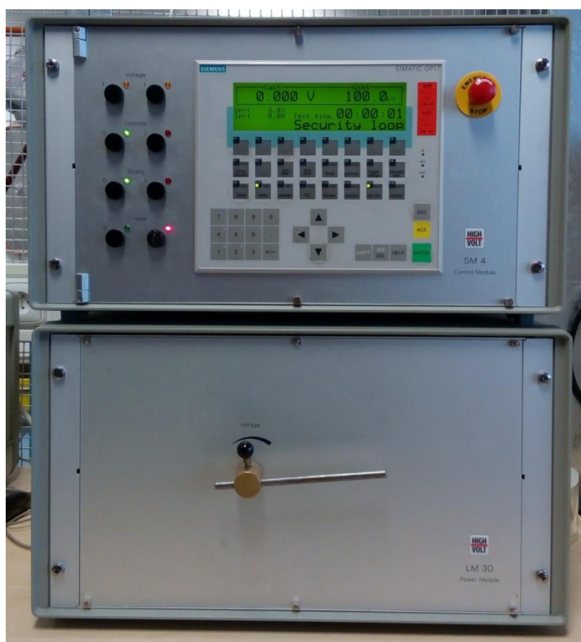
Obr. 3: Ovládací modul SN4 a výkonový modul LM30 od firmy High Volt
