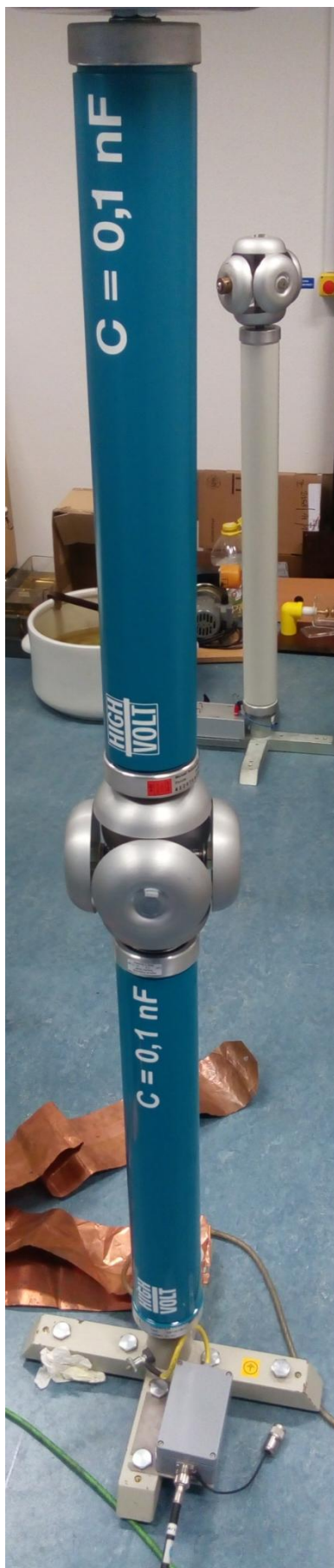
Obr. 5: Kapacitní dělič kondenzátorů CDTH 0615B10
