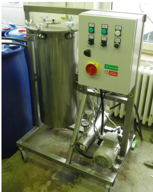
Obr. 7: Perkolační zařízení pro výrobu elektroizolační kapaliny ENVITRAFOL
