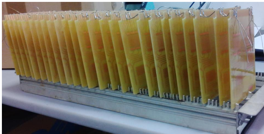
Obr. 4.12 Pořadník se zapájenými zkušebními vzorky pro zkoušku vlhkým teplem
