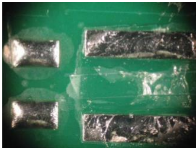
Obr. 3.5 Delaminace špatně přilnutého povlaku po zkoušce řezem. Převzato z [5]
