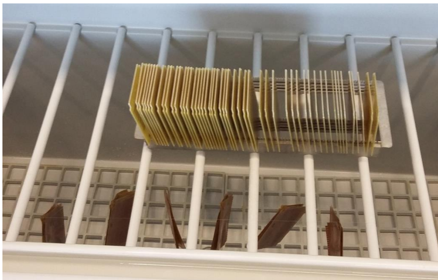
Obr. 4.5 Foto zkušebních vzorků vložených do zkušební komory pro solnou mlhu
