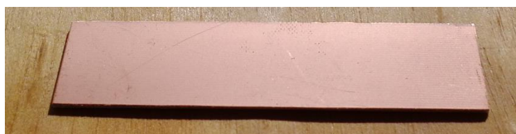
Obr. 4.17 Ukázka nalakovaného přířezu z FR-4 před zkouškou
