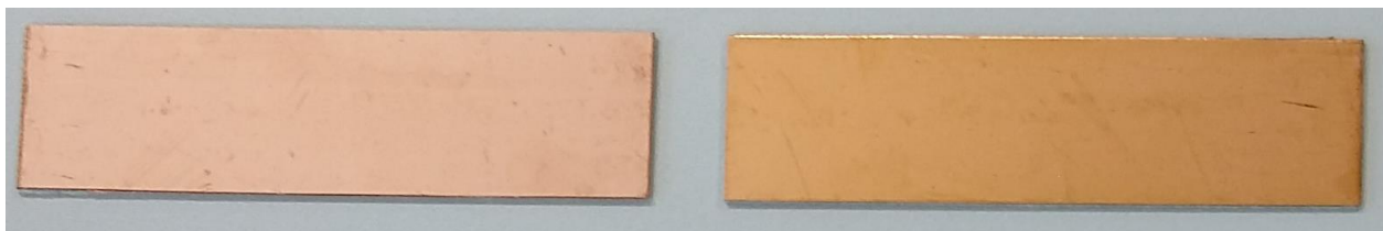
Obr. 4.19 Porovnání čistě průhledného a teplotním šokem ztmavlého povlaku (vpravo)
