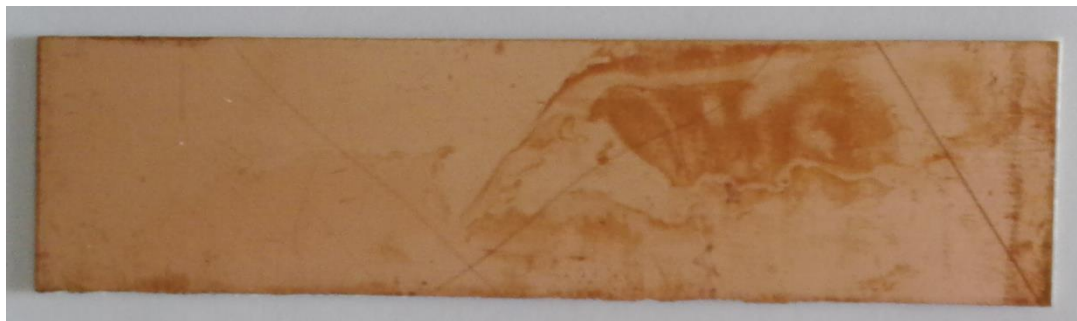
Obr. 4.21 Mléčný povrch substrátu FR-4 s fluoropolymerem Novoc
