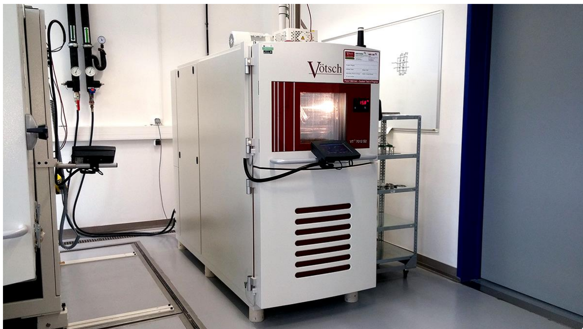
Obrázek 6.12 - Klima komora VT 3 7012 S2 od firmy Vötsch s testovanými vzorky
