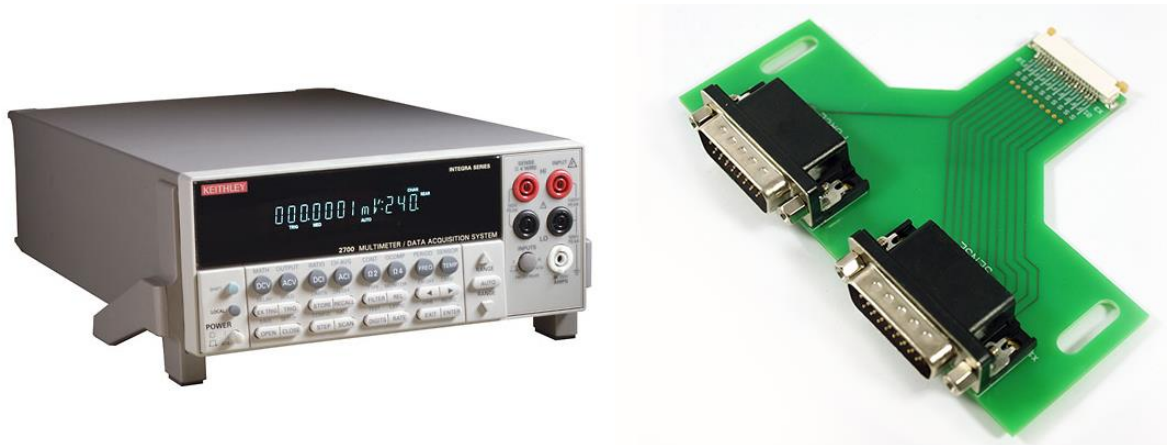
Obrázek 5.6 – DMM Keithley 2700 [61] a FPC konektor propojený s D-sub konektorem
