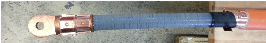
Obrázek 7: Nalisované kabelové oko a jednotlivé vrstvy kabelu
