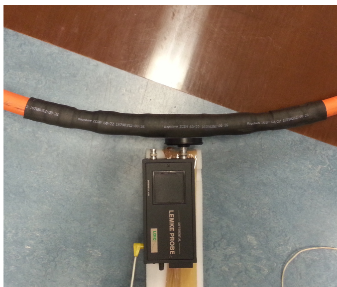
Obrázek 43: Lokalizace částečných výbojů LEMKE sondou
