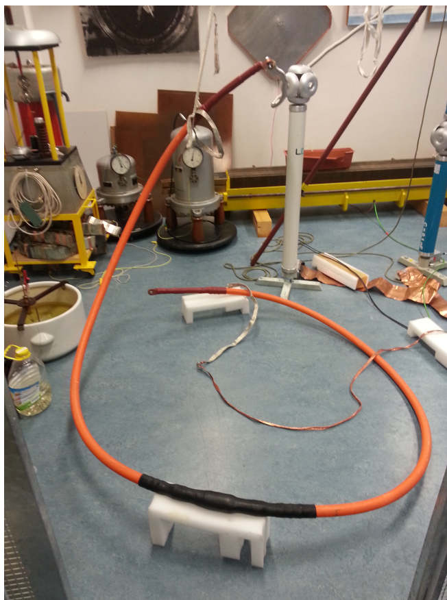
Obrázek 42: Zapojení při měření částečných výbojů globální metodou
