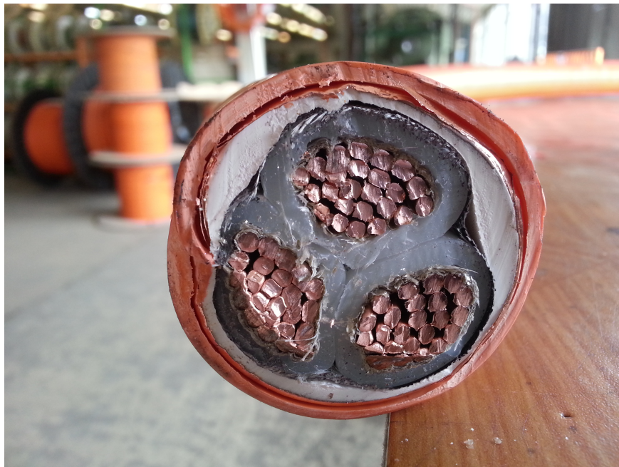
Obrázek 45: Konstrukce kabelu 6-CHKFE-V 3x120 SM (vzorek 3.1)
