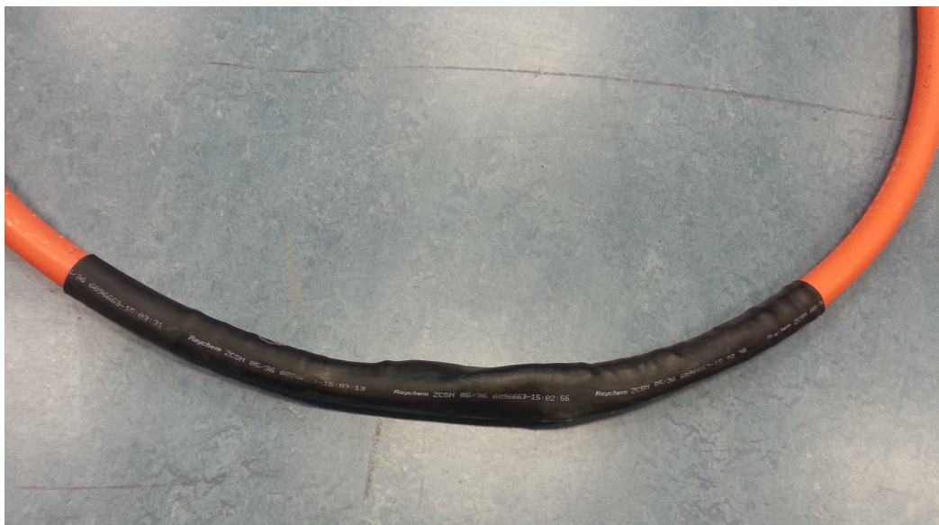
Obrázek 40: Hotová kabelová spojka (vzorek 3.1)
