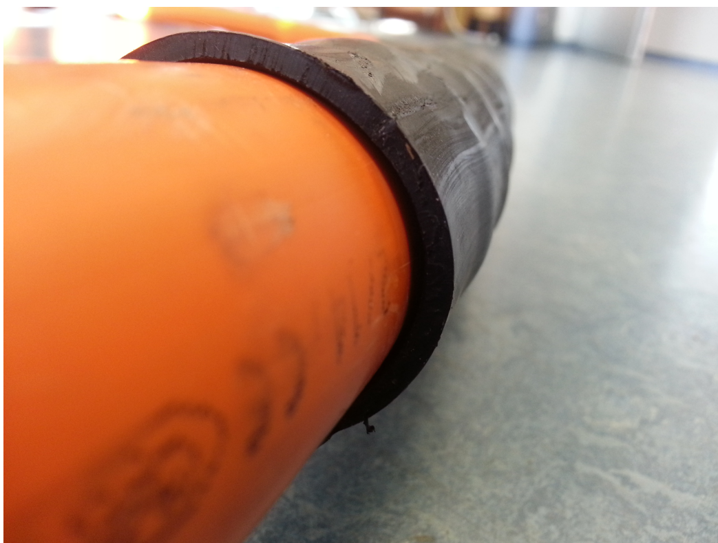
Obrázek 41: Nedokonale smrštěná trubice spojky (vzorek 1.2)
