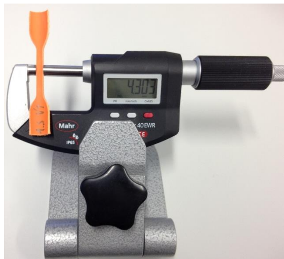
Obr. 3.3.6: Fotografie měření šířky krčku prováděná digitálním třmenovým mikrometrem značky Mahr
