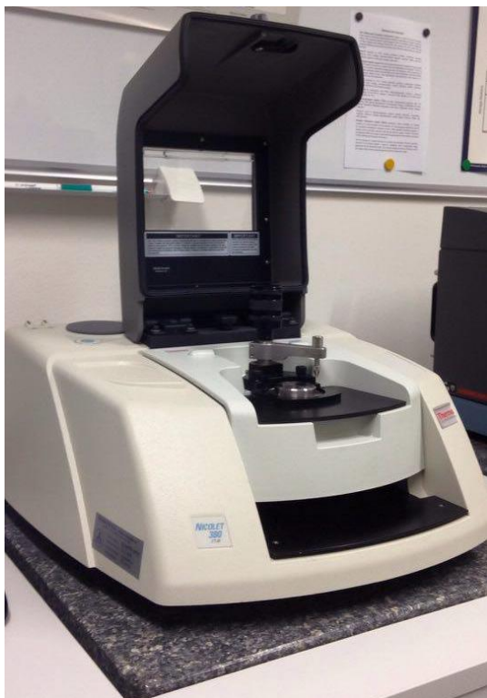
Obr. 3.3.7: Přístroj Thermo Scientific Nicolet 380 pro infračervenou spektroskopii s Fourierovou transformací (FTIR)
