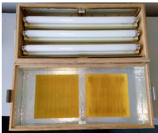
Obr. 3.3.1: Fotografie otevřeného UV boxu se třemi fluorescenčními lampami, ve spodní části jsou dvě podložky pro uložení zkoušeného materiálu
