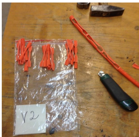
Obr. 3.2.5: Vyrobené zkušební lopatky z pláště elektrického kabelu, sada vzorků „V2“
