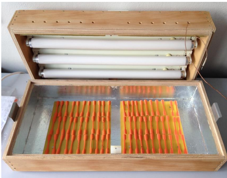
Obr. 3.3.3: Uložení 30 lopatek sady V1 vlevo a 30 lopatek sady V2 vpravo na vyzdviženém plastovém dnu v UV boxu
