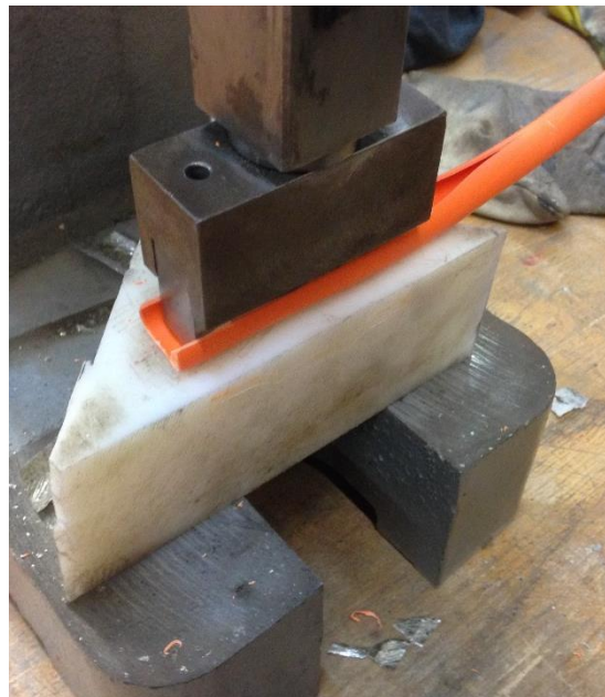
Obr. 3.2.4: Detailní fotografie vyseknutí lopatky z kabelové pláště
