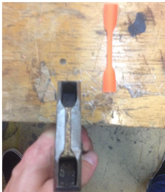
Obr. 3.2.2: Fotografie hlavy raznice s rozměry definovanými normou ČSN EN 60811-501, v pozadí je již vyražená zkušební lopatka
