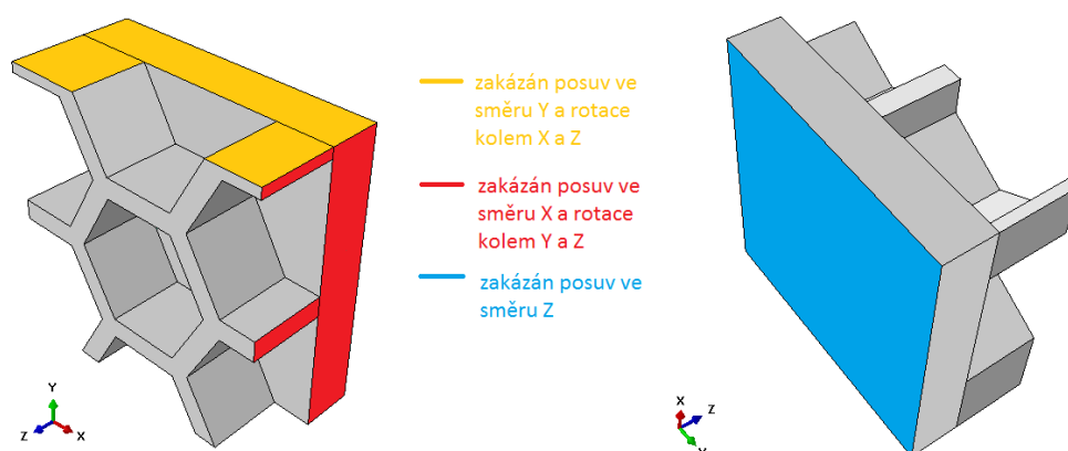
Obrázek 5.5: Definice okrajových podmínek pro tlakovou zkoušku
