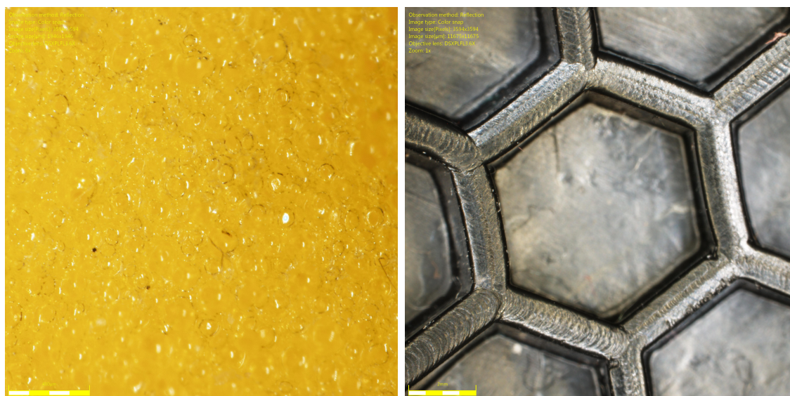
Obrázek 3.3: Mikrostruktura pěnového materiálu použitého v chrániči SCL2 (vlevo) a detail voštinové struktury z chrániče PSÍ (vpravo)
