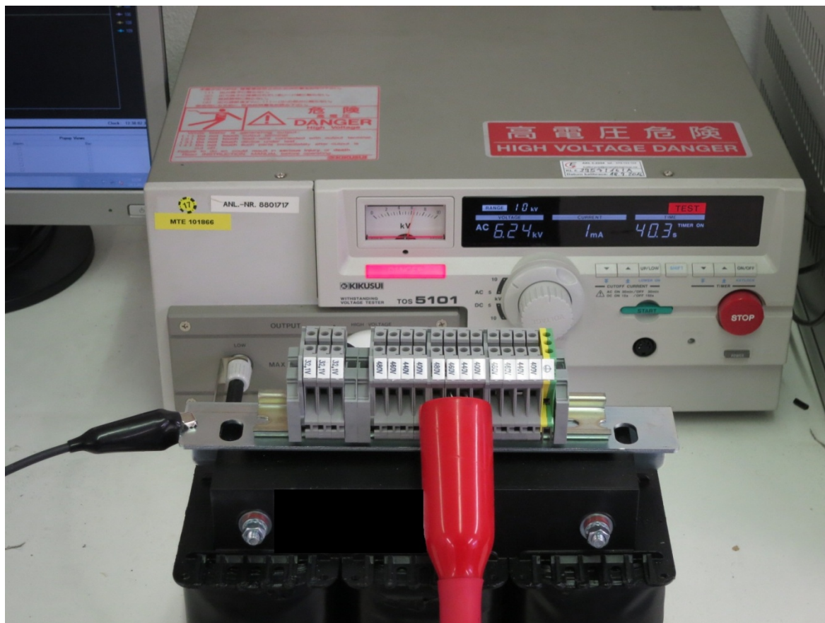
Obr. 2.8 Měření elektrické pevnosti vysokým napětím
