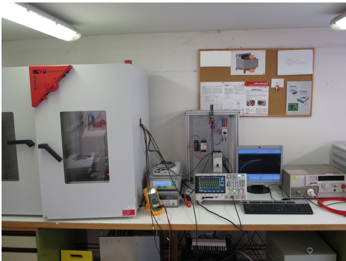
Obr. 2.3 Měřicí pracoviště pro typové zkoušky transformátorů
