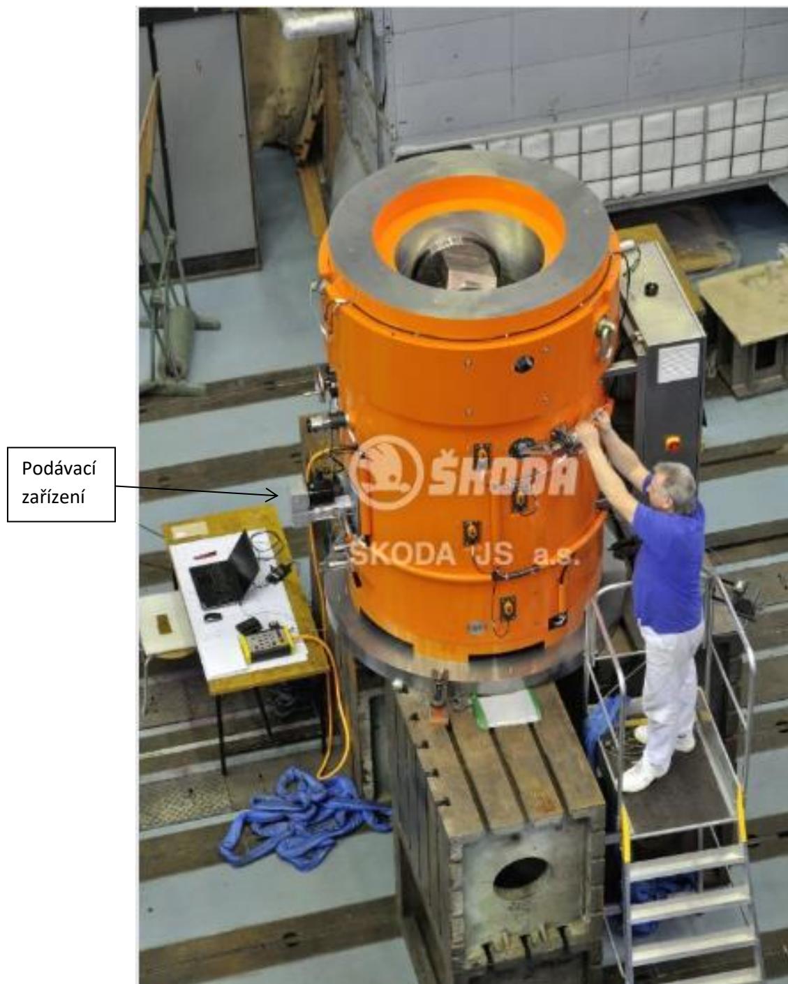
Obr. 10: Zařízení na likvidaci čidel KNI a termočlánků pro reaktor VVER 1000 (ETE) [7]
