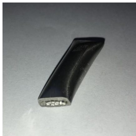
Obr. 14: Odštěpek KNI čidla i s vodiči uvnitř
