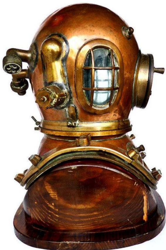
Obr. 4. 2. Siebeova helma z roku 1840 – toto je první masově rozšířená potápěčská přilba od Augusta Siebeho. Tento prototyp byl používán až do dvacátého století, kdy byl vynalezen moderní potápěčský oblek.
