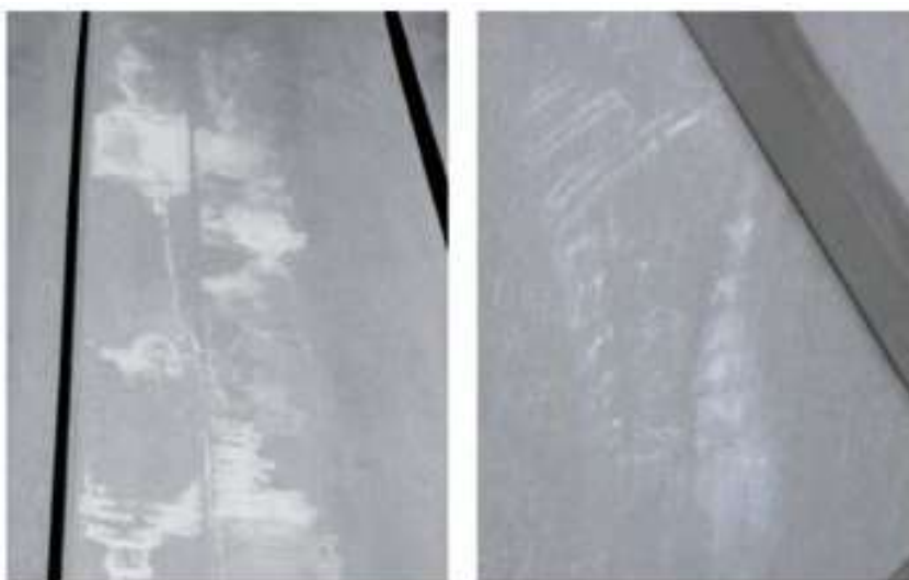
Obr. 1 Korozní produkty zinku vytvořené při skladování a špatném mechanickém zacházení s plechem. [4]
