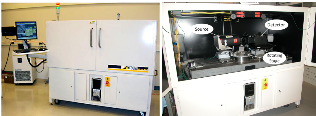
Obrázek 3.5: Mikro-CT Xradia XCT 400 (NTC ZČU Plzeň). Pravý obrázek znázorňuje uspořádání zdroje záření, detektoru a rotující platformy pro upnutí vzorku
