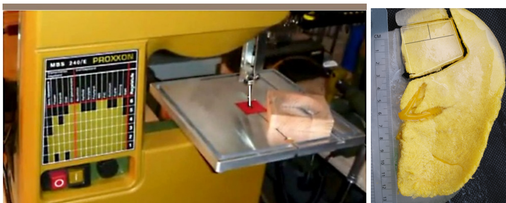
Obrázek 6.11: Oddělení vzorku od korozivního preparátu celých jater. Vlevo pila Proxxon Micro Band Saw 240-E, vpravo pak oddělený vzorek. Viz [34]
