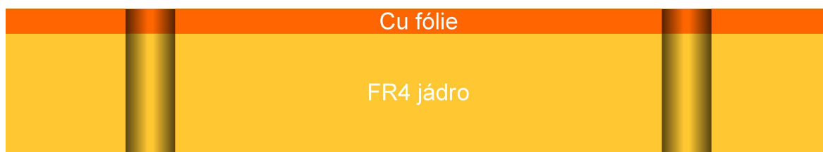
Obr. 1.5 Ilustrace jednostranné desky plošných spojů se dvěma otvory
