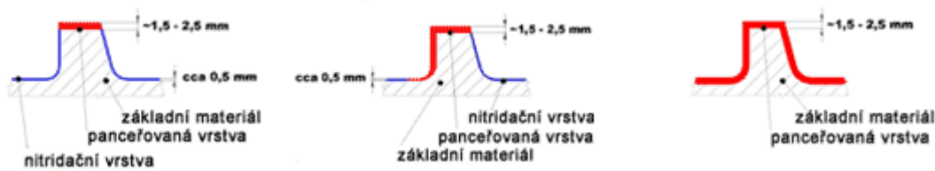
Obr. 20 Způsoby nitridování šneků[38]
