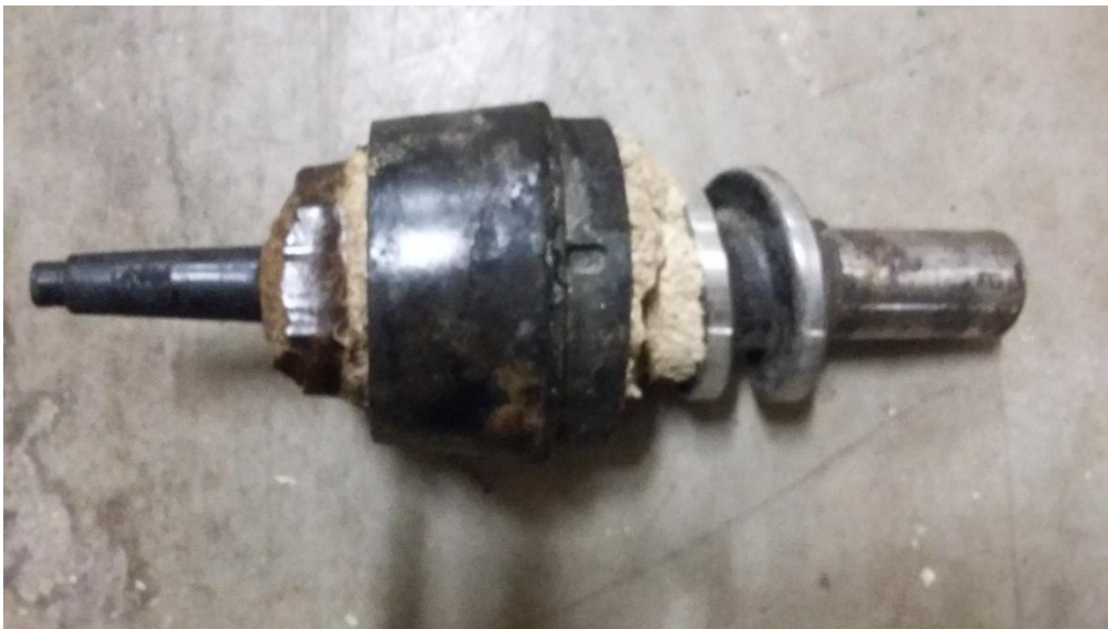
Obr. 6 Briketa tvořící se v primární matici [24]
