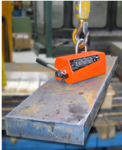
Obr. 17 Přeprava železné desky jeřábem, pomocí permanentního magnetu (převzato z [10])
