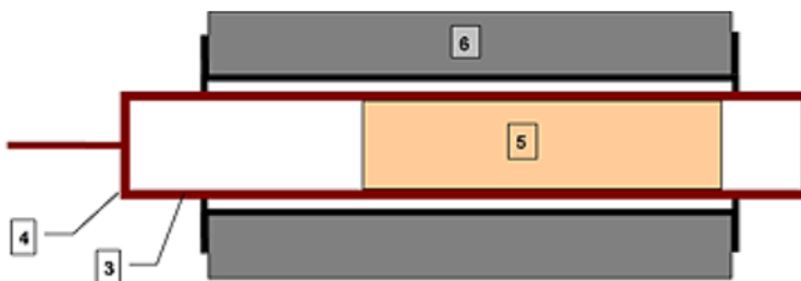
Obrázek 3-9 Starý typ PGKK s běžným modulem (Модули кабельных проходок с эпоксидной изоляцией для возобновления кабельных проходок типа ПГКК, 2013), 1 – starý modul, 2 – starý kabel, 3 – tělo průchodky, 4 – čelní strana tělesa 5 – biologická ochrana, 6 – stěna kontejneru
