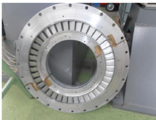
Obrázek 2.3: Disk s rozváděcími lopatkami [1]
