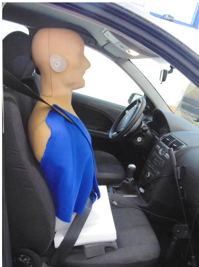
Obr. 4.3: Umístění umělé hlavy s torsem v přední části vozu
