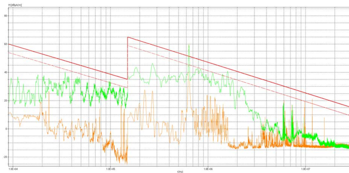
Graf 4: Naměřené elektromagnetické emise v pásmu 9 kHz až 30 MHz (jízdní zkouška)
