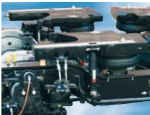
7 – SIEMENS SF 4000 JLDG – detail sekundárního vypružení [1 str. 52]
