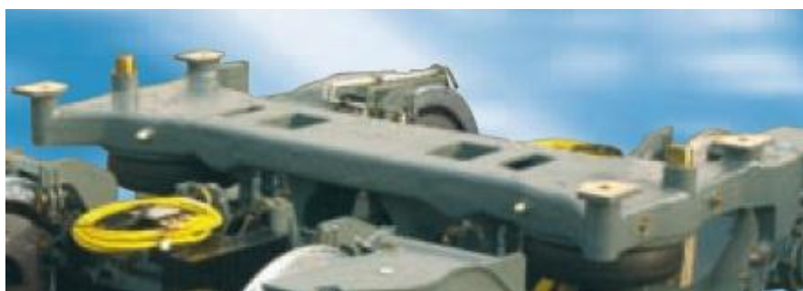
8 – SIEMENS SF 5000 E TDG – detail sekundárního vypružení [1 str. 54]
