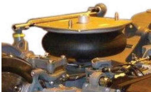
6 – ALSTOM CL 541 – detail sekundárního vypružení [2 str. 21]
